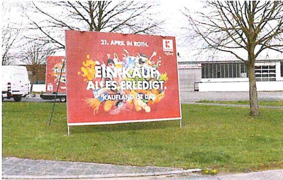
Die Großfläche 18/1 (9qm) ist eine freistehende Werbeanlage mit feuerverzinktem Stahlgestell und Erdbuchsen, oder als Wandelement, mit Birkenholzplatte, ohne Nut und Feder gefertigt, mehrlagig geschäftet und wasserfest verleimt, verzinkter Stahlrahmen aus U-Profil, Ecken auf Gehrung gesägt und fest verschweißt
