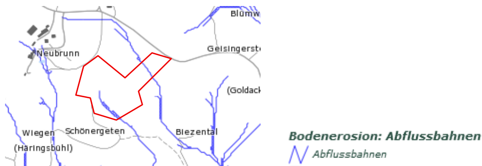
Abb. 10: Starkregenrisikomanagement – Abflussbahnen (Quelle: LGRB Kartenviewer), Plangebiet rot
